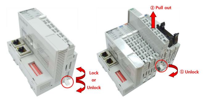
Как показано на рисунке выше (слева), для фиксации модуля серии G его следует закрепить на DIN-рейке фиксирующими защёлками. Для этого откиньте верхнюю часть фиксирующей защёлки.
